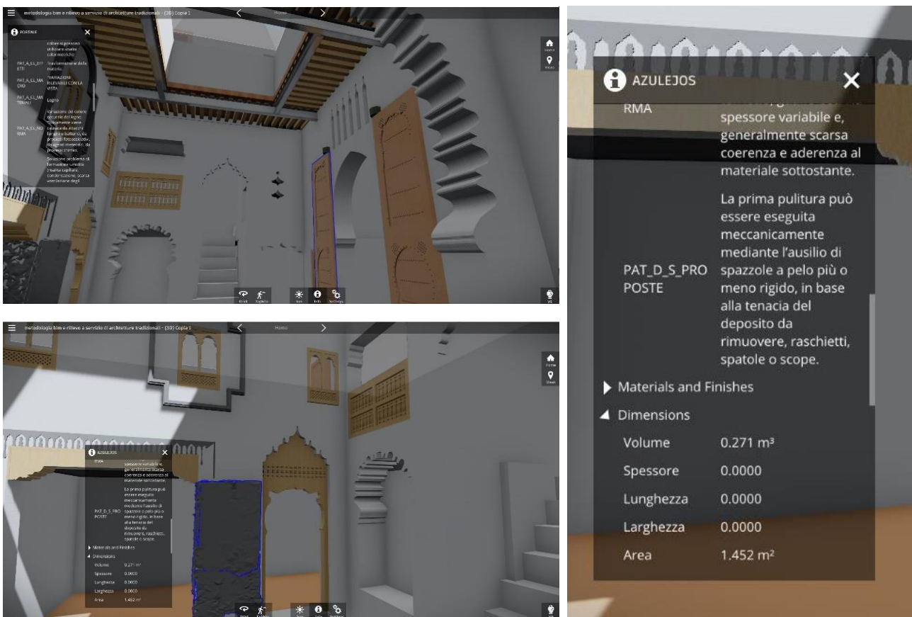
Informazioni parametriche della famiglia derivante dalla nurbs importata come patologia “deposito superficiale” (tesi di laurea di Giacomo Sorino, metodologia BIM e rilievo a servizio di architetture tradizionali, 2018)
