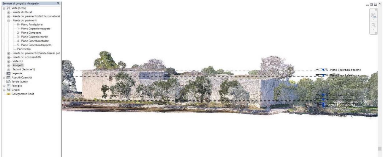
Inserimento livelli nel modello, a partire dalla nuvola di punti (tesi di Domenico Modugno, Il rilievo del costruito nel BIM, Masseria Macchia Trappeto, 2016)
